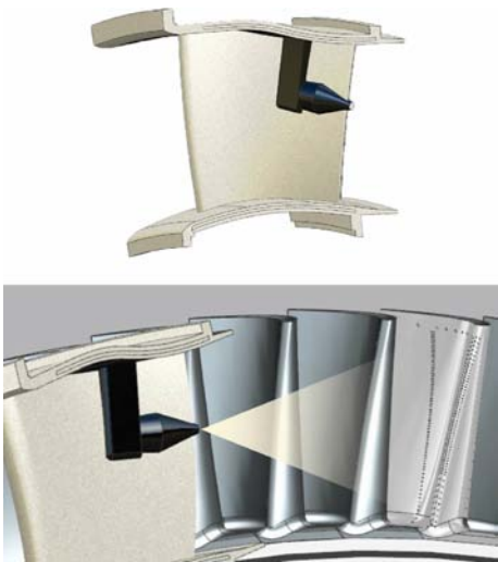
图 3 相机安装示意图 Fig. 3 Sketch map of camera installation
